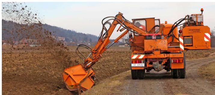
Mit der selbstfahrenden Grabenfräse wird die Arbeit schnell und preiswert erledigt. Der rotierende Fräskopf wurde speziell angefertigt.
